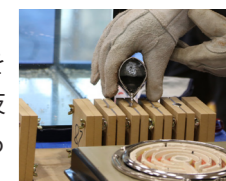
▼シリコンシートを挟んだ木枠に300℃に溶かしたスズを流し込む
