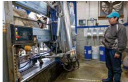
自動で牛を感知する自動搾乳機
