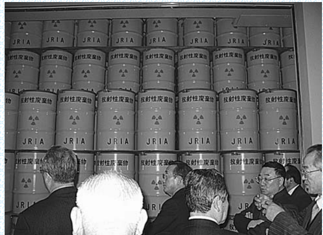
処理後の放射性廃棄物が保管されている貯蔵庫
