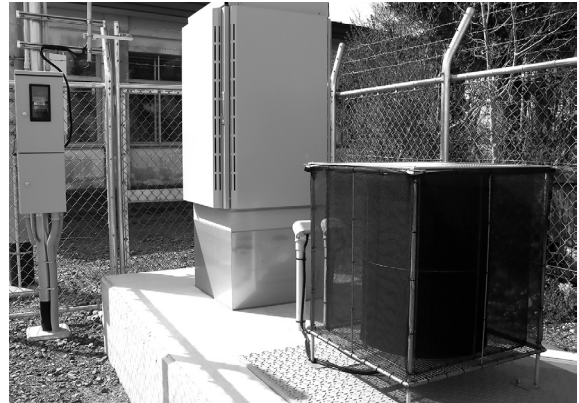
本年2月に東北防衛局で設置した砲撃音自動測定装置 (平沼出張所隣)
