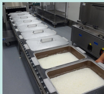
▼給食センターの炊飯器 1つの釜で7kgの白米を炊きます
