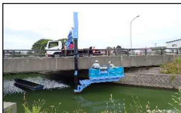
橋梁点検車 BT-200 活用状況 高所点検・撮影用昇降ポール (桁下進入が困難な状況) 技術概要
